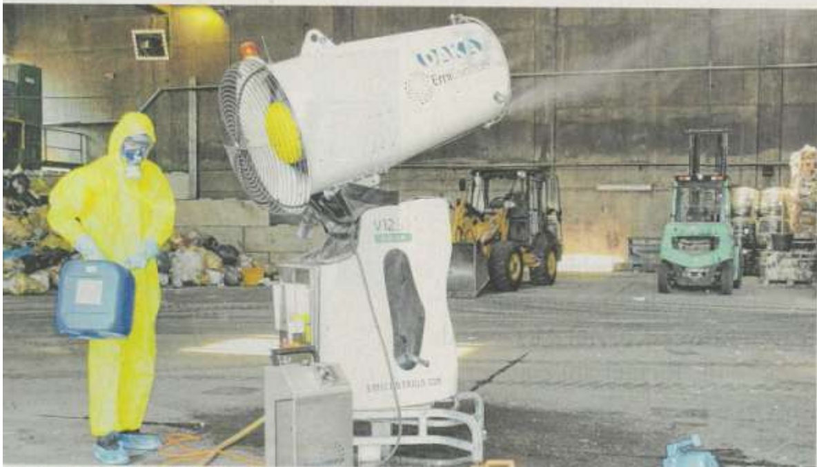
Die modifizierte Schneekanone kann vor allem für Hallen eingesetzt werden, aber auch Spielplätze lassen sich so desinfizieren.
